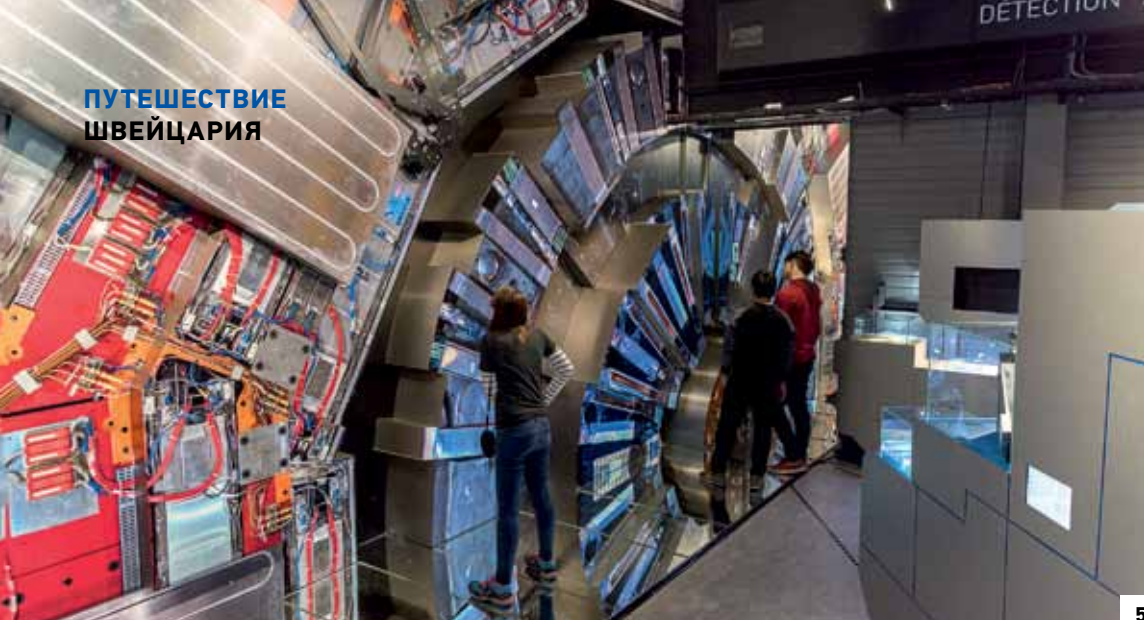
5. В музее «Микрокосм» среди прочего выставлена копия ATLAS – самого большого из четырех детекторов коллайдера, в которых происходят столкновения частиц. Это лишь часть конструкции, но в масштабе 1:1. Сам детектор высотой 46 м расположен в земле в специальной нише
